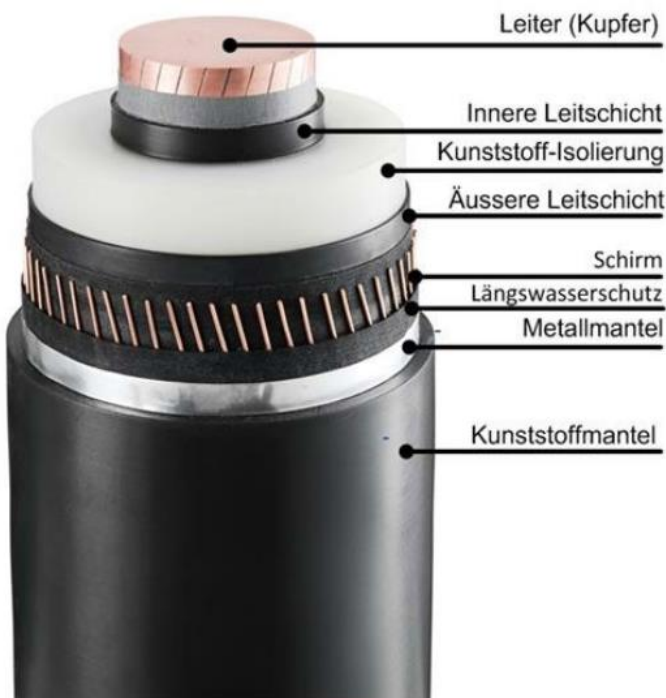
Abbildung 3-2: Beispielhafter Kabelaufbau Rhein-Main-Link
