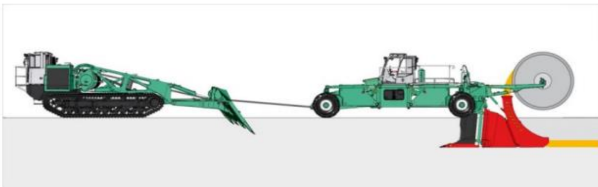
Abbildung 3-3: Einpflügen von Schutzrohren, Quelle: Walter Föckersperger GmbH 2020
